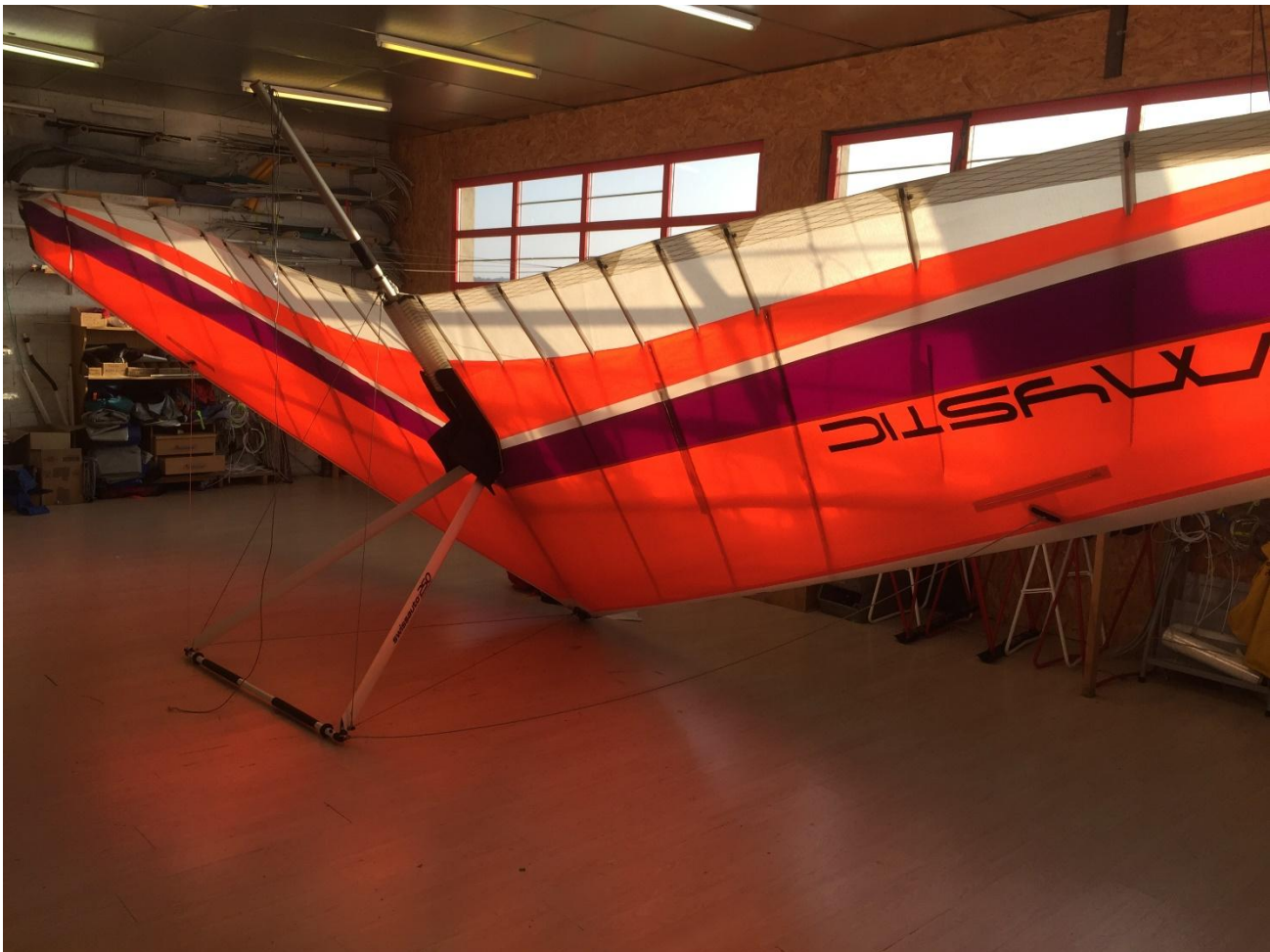
14 – Mettre en place les balestrons et les lattes d’intradós
