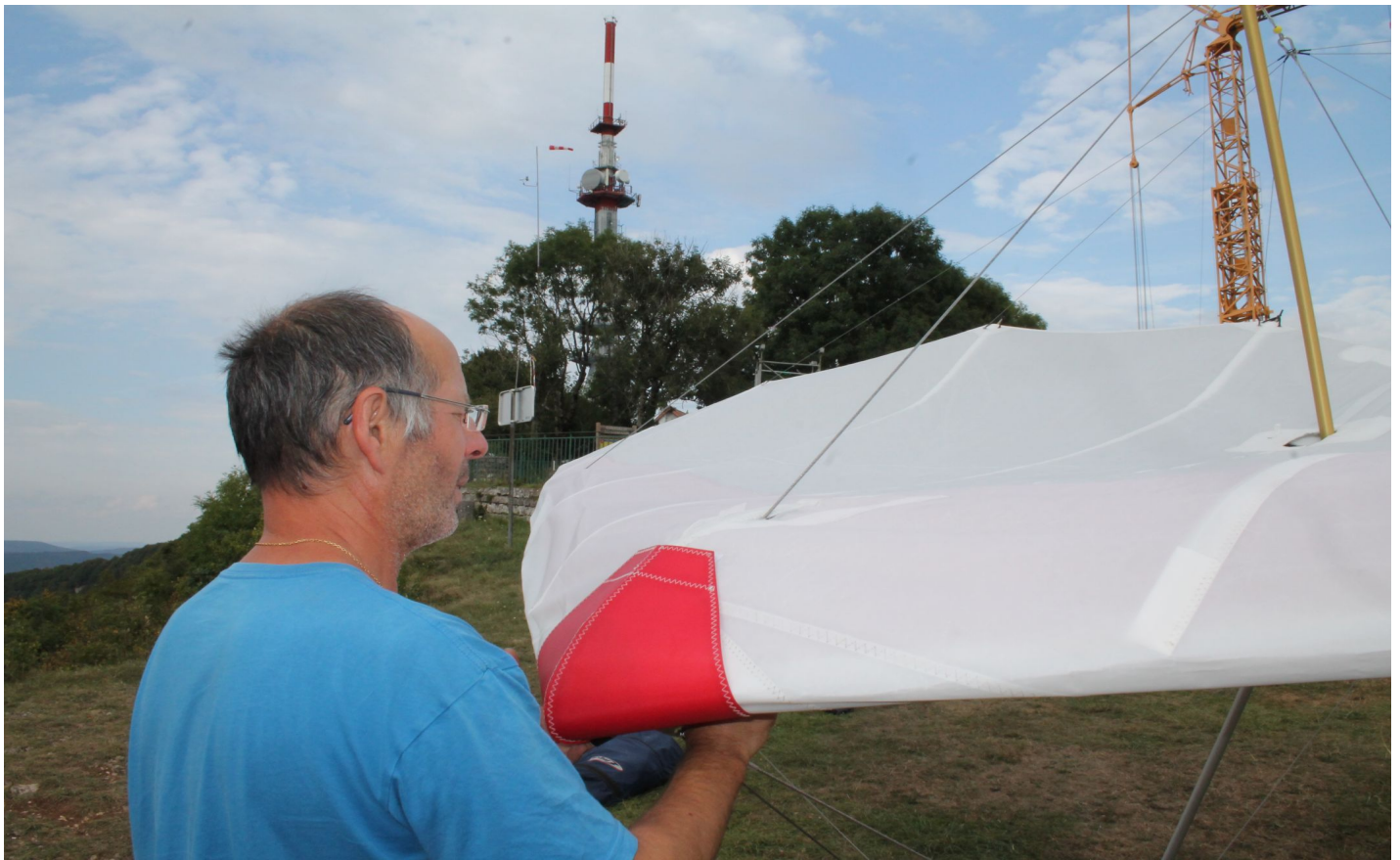
Bild 8 Vordere Unterverspannung einhängen und Nasenverkleidung montieren
