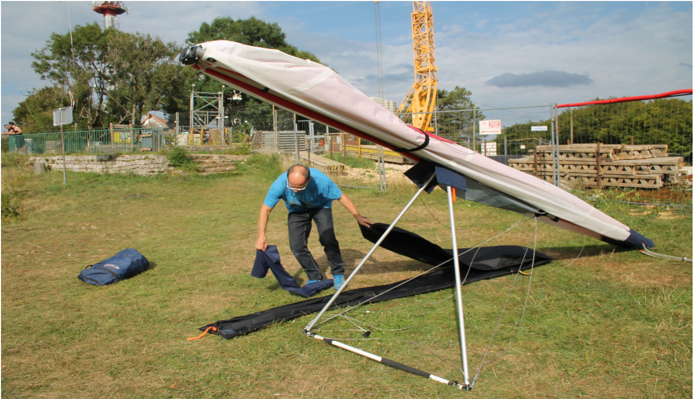
Bild 3 Das Gerät auf das Trapez stellen und den Packsack entfernen
