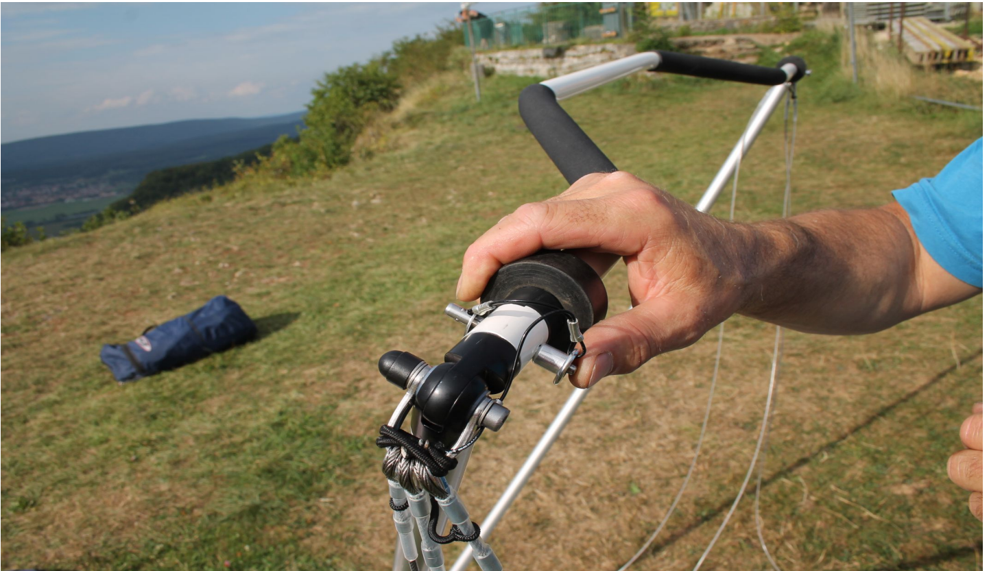
Bild 2 Trapez zusammen stecken und mit den Quickpins plus Sicherungsscheibe sichern.
