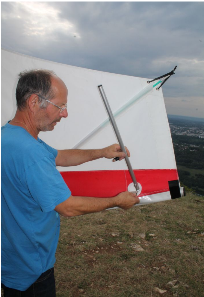
Bild 8 Vordere Unterverspannung einhängen und Nasenverkleidung montieren
