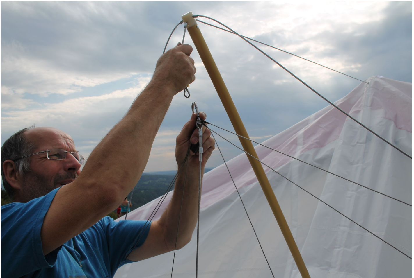
Bild 5 Pitchleinen mit hinterer Oberverspannung am Turm einhängen
