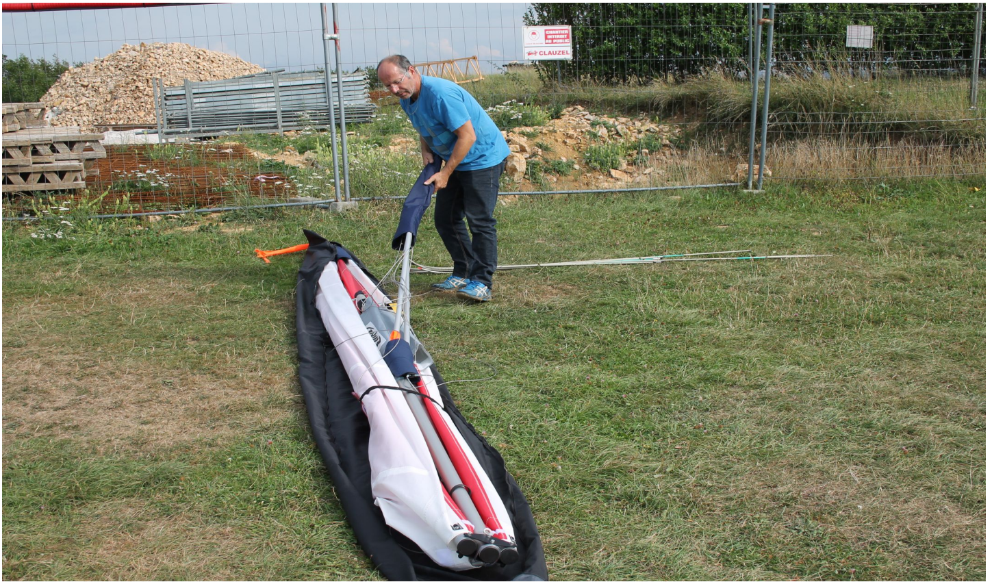
Bild 1 Den Sol'R mit dem Achterliek zum Wind ablegen und den Packsack öffnen.
