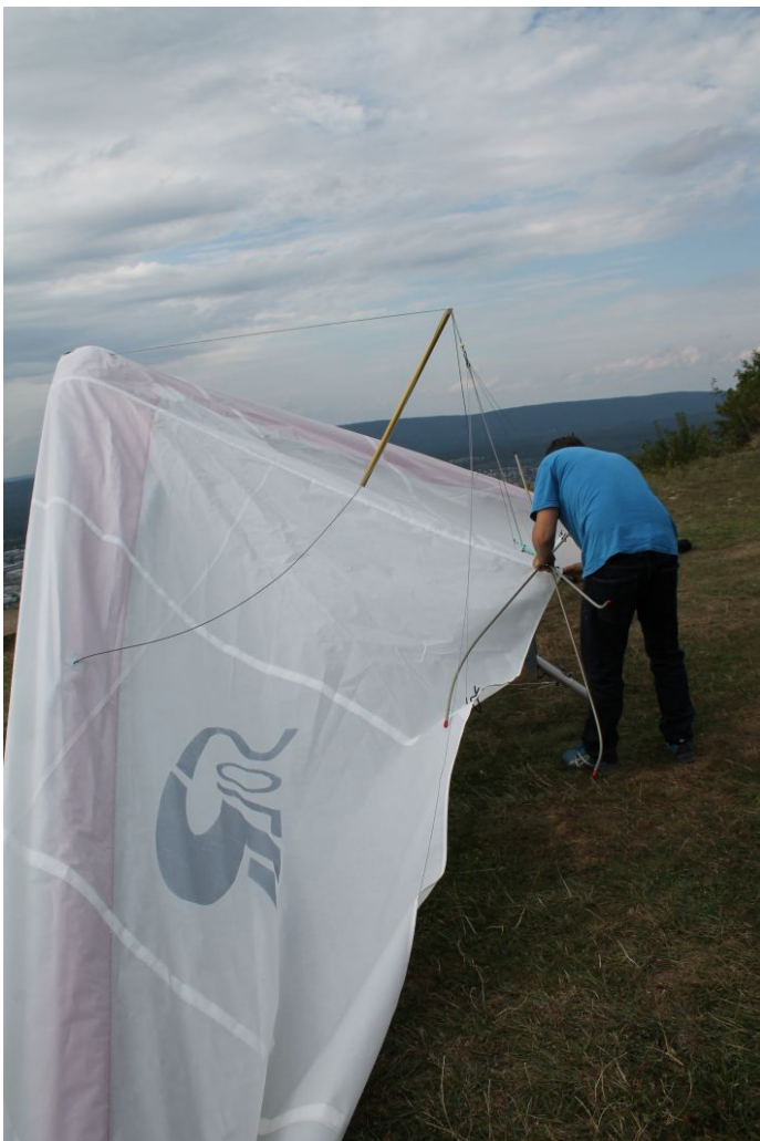
Bild 5 Pitchleinen mit hinterer Oberverspannung am Turm einhängen
